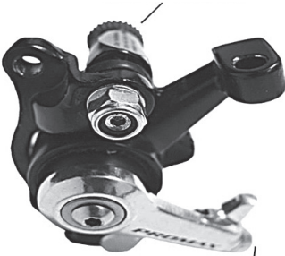
Klemmschraube für Bremszug
