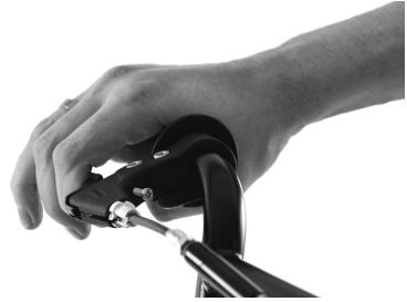
Korrekte Position des Bremshebels
